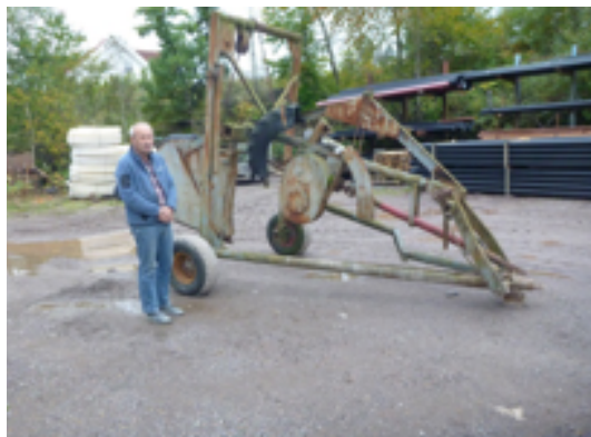
Runar Ommedal viser deres første gravehjulsmaskin. Her mangler selve grøftehjulet. Hjulet er klart til montering.
